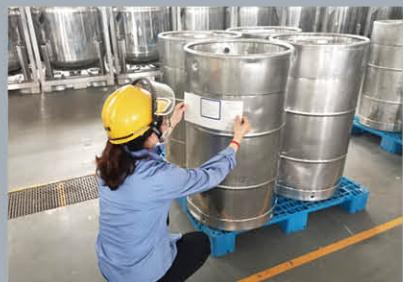
▲成品标签扫描分装（一次性粘贴），成品标签提前打印，电解液成品标签分装时，直接贴带有二维码的成品标签，扫描枪直接扫描，提高了生产效率。
